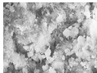
一般混凝土中的水泥在 5,000 倍電子顯微鏡下呈現未水化的狀態
