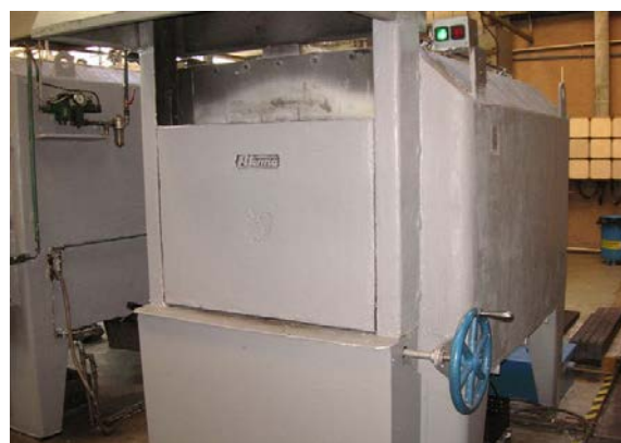
淬火爐表面噴塗 3mm 「綠能 HIC 陶瓷保溫塗料」後，爐門表面溫度由 100 ^{\circ} C 降至 65 ^{\circ} C。
