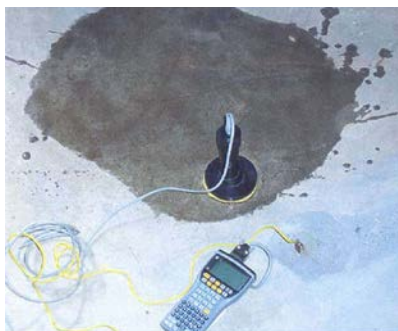
以 GalvaPulse 儀器測量地坪的鏽蝕情況
