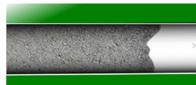
水泥砂漿潤管易造成混凝土在輸送管中卡管
