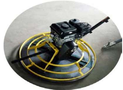
以粉光機將水泥漿鏟抹入裂縫
